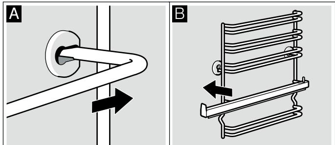
Okviri vodilica pristaju samo s desne ili lijeve strane. Pazite na to da razina 1 i 2 dolje te razina 3, 4 i 5 gore kao na slici B. Izvlačna vodilica mora se moći izvući prema naprijed.
