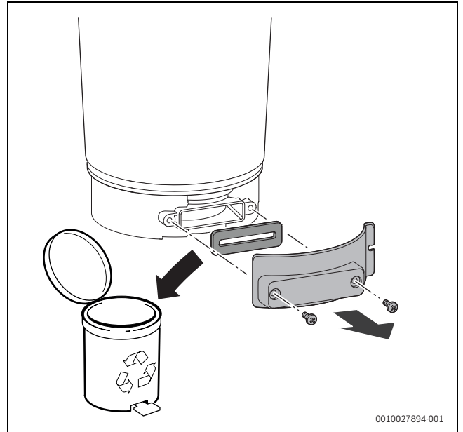
Sl.65 Otvaranje otvora za ispitivanje
