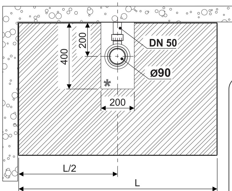
\* **U slučaju da je instalacijski šaht većih dimenzija od preporučenih, ispuniti ga niskoekspandirajućom 2-komponentnom PU pjonom neposredno prije konačne ugradnje tuš kade. Količinu PU pjene dozirati na način da nakon ekspanzije ispuni šaht i bude u kontaktu s dnom tuš kade.**
